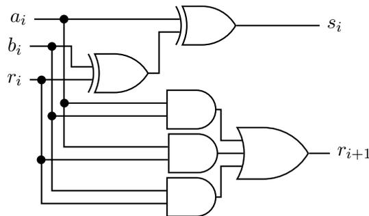
**Question 14** Calculer la valeur numérique des temps de propagation des entrées vers les sorties  $s_i$  et  $r_i$ , respectivement  $\Delta s_i$  et  $\Delta r_i$ .
